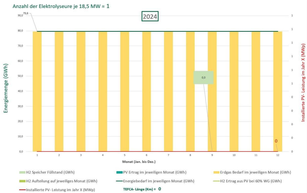
Am Beginn des Jahres 2024 wird die Energie für die Gasturbinen ausschließlich aus dem Erdgas bereitgestellt, der Anteil an grünem Wasserstoff ist also gleich Null.
